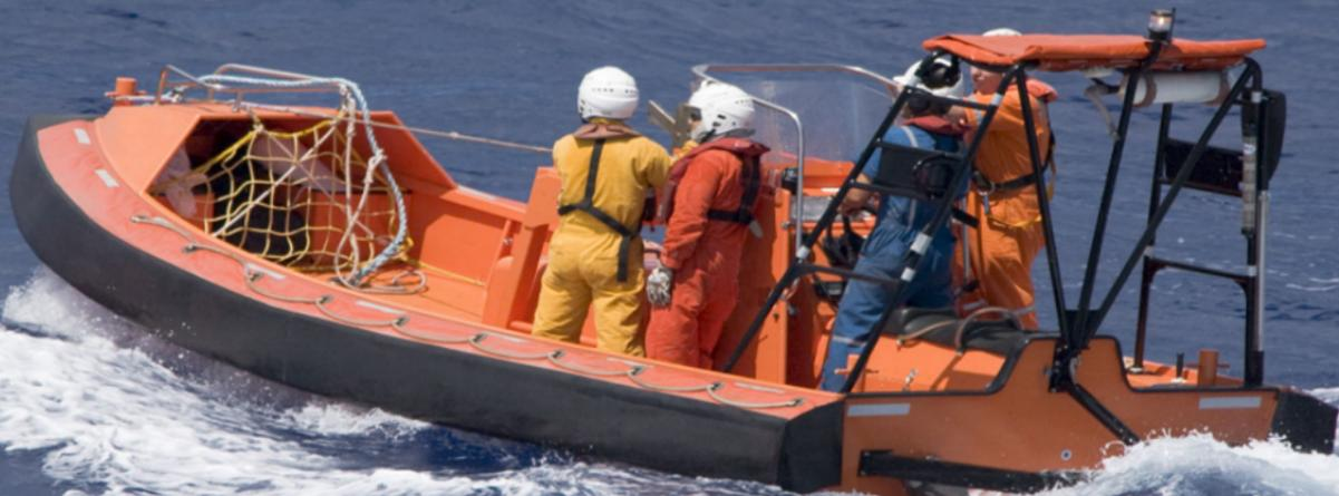
现代的刚性橡皮艇（RIB）是具有刚性底板和坚固船体。船底部的外部形状允许其更容易地切穿波浪，在快速行驶时提供更舒适的行驶。船体的结构能够支撑更强大的船尾安装的船用挂机或内置发动机。
