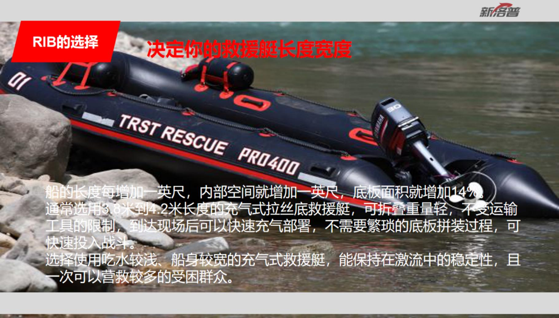
船的长度每增加一英尺，内部空间就增加一英尺，底板面积就增加14%。通常选用3.8米到4.2米长度的充气式拉丝底救援艇，可折叠重量轻，不受运输工具的限制，到达现场后可以快速充气部署，不需要繁琐的底板拼装过程，可快速投入战斗。
